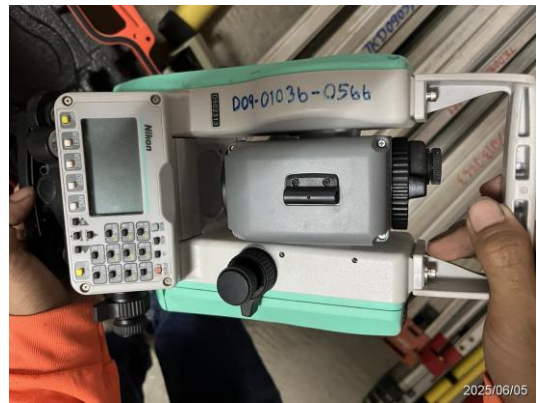
รูปที่ 3-61 กล้องสำรวจ (Total Station)
